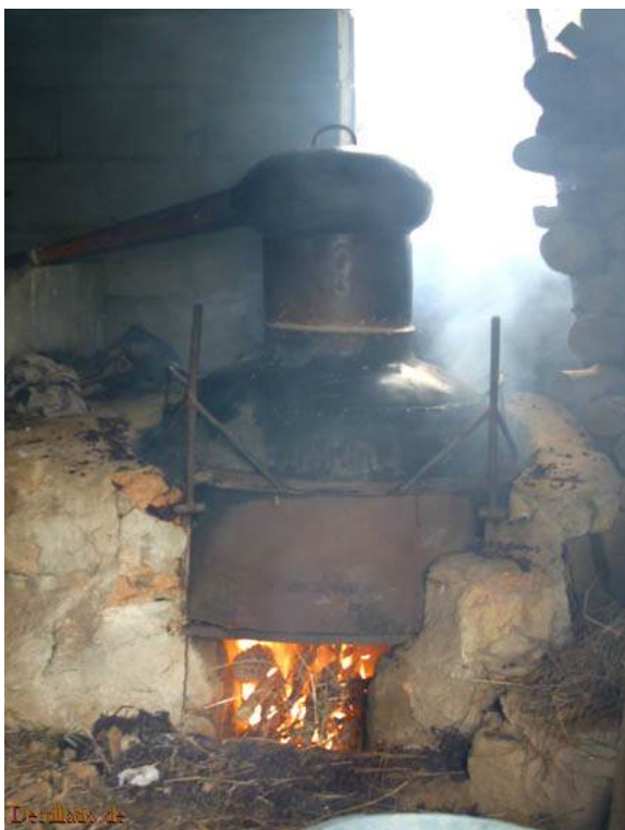
2 Trester wird erhitzt. Flüchtige Substanzen steigen auf und strömen durch den Seitenarm zum Kühlbecken
